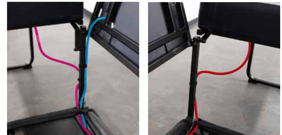
Abbildung 17: Kabelführung von HEAD und BODY (links) und FEET (rechts)
